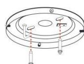
**Instalación en el techo de hormigón**
